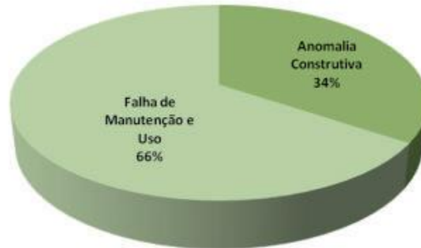
Figura 1 - Incidência dos acidentes prediais por tipo e origem
