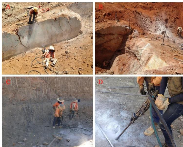
Figura 62 – a) Perfuração de bancada utilizando martelo-rotopneumático na horizontal; b) Perfuração de bancada utilizando martelo-rotopneumático na vertical; c) Hastes utilizadas para perfuração com martelo-rotopneumático; d) Pó branco saindo da bancada indicando que a perfuração está no pegmatito à amazonita.
