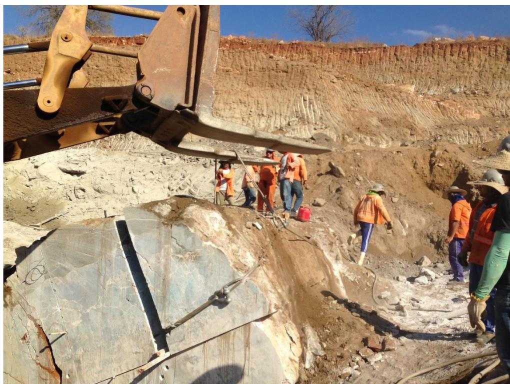
Figura 65 – Tombamento do bloco. Os cabos de aço são presos ao redor do bloco e este é transportado até o pátio de blocos.
