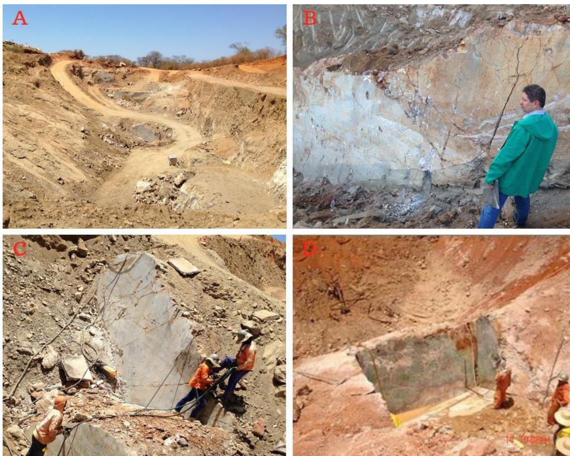
Figura 60 - a) Vista geral das bancadas da mina; b) Bancada com aproximadamente 2 metros; c) Geometria em “L” das bancadas; d) Gaveta.
