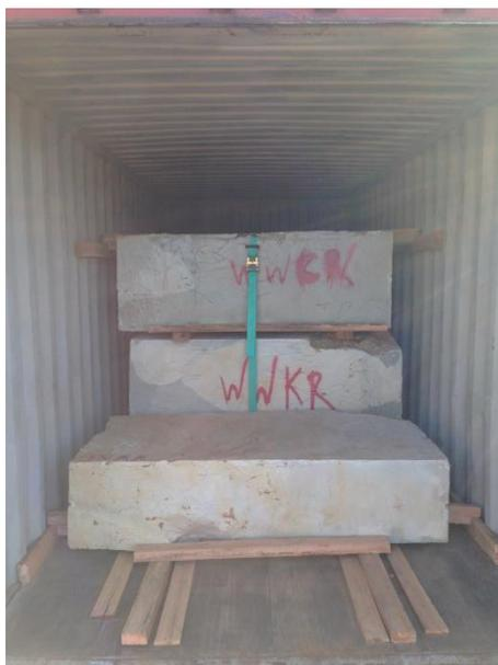
Figura 70 – Blocos colocados organizadamente e devidamente calçados no container.
