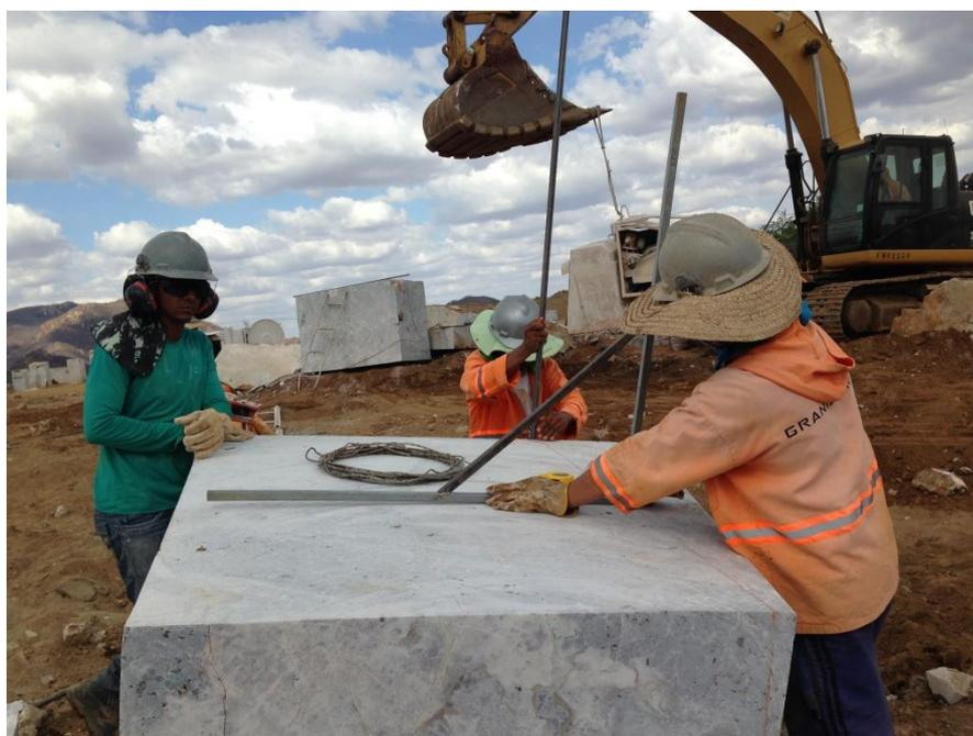
**Figura 66 – Desenho com giz de cera no bloco com auxílio de esquadro para definir locais aonde serão realizados os cortes finais.**
