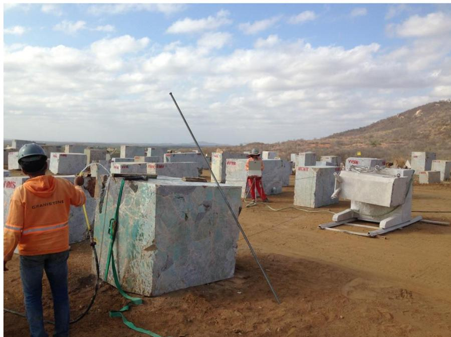
Figura 67 – Pátio de blocos e bloco sendo cortado com auxílio da máquina de fio diamantado.
