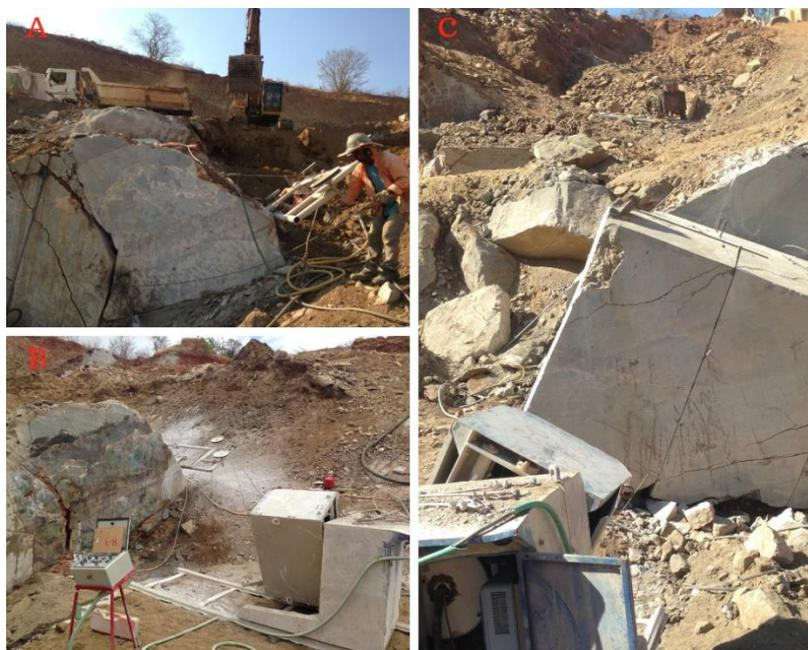
Figura 63 – A) Preparação de corte de bancadas com fio diamantado e auxílio de sistema de polias; B) Corte latitudinal em bancada utilizando fio diamantado; C) Corte longitudinal em bancada utilizando fio diamantado.
