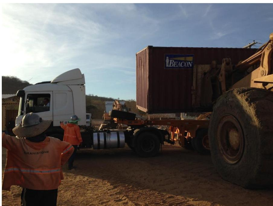
Figura 71 – Container sendo colocado no caminhão com auxílio da carregadeira. Após essa etapa o container é levado aos portos onde será embarcado até chegar no local de destino.
