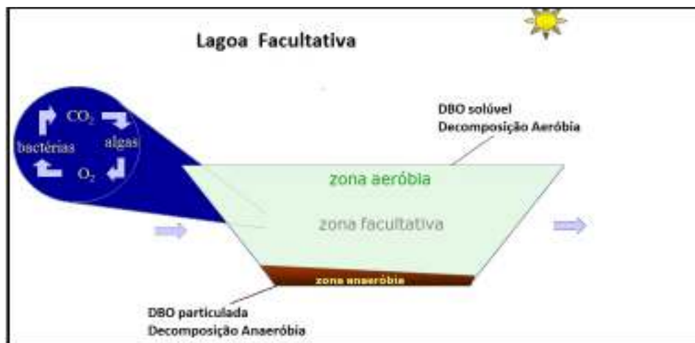
Figura 3 – Zonas existentes em uma lagoa facultativa e relação entre bactérias e algas
