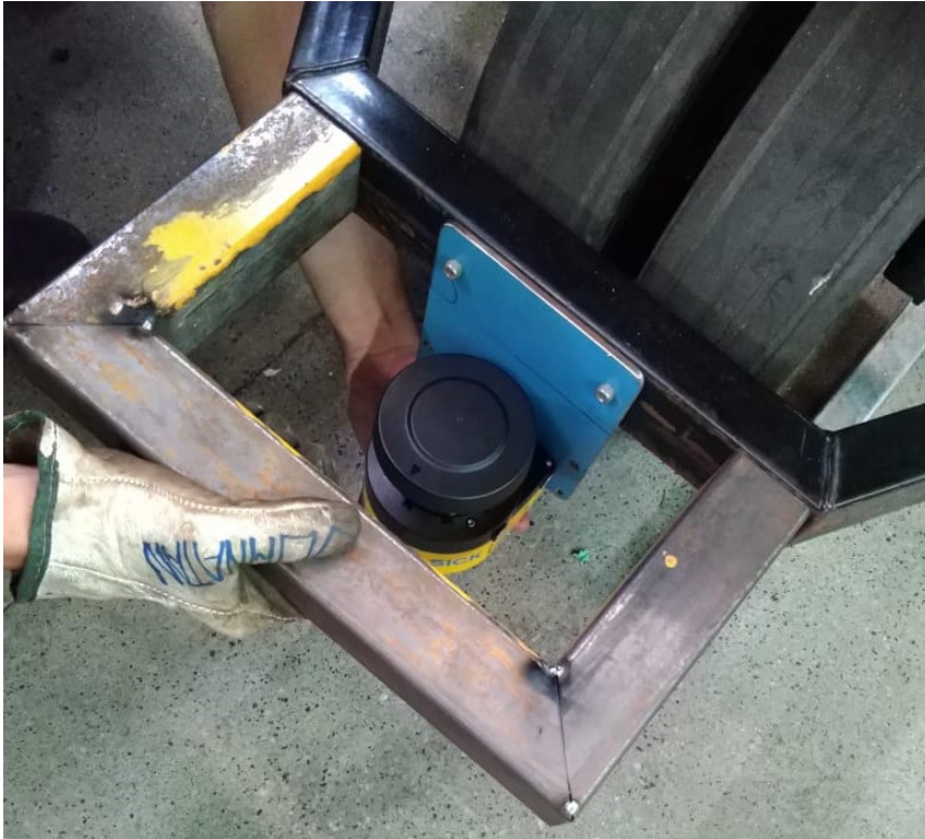
Figura 14 – Local de instalação do Sensor de Segurança
