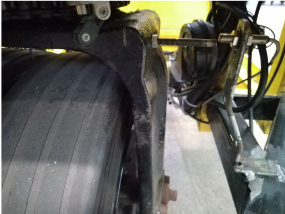
Figura 21 – Local de instalação do sensor indutivo
