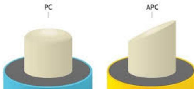
Figura 36 – Conectores tipo PC e APC
