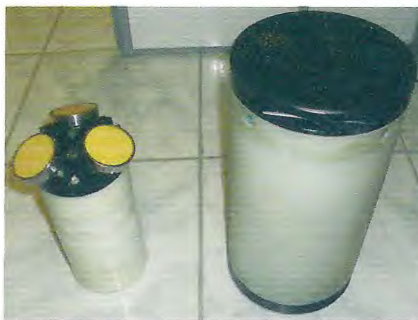
Figura 12 – Aparelho usado para medir e armazenar os dados de ADCP
