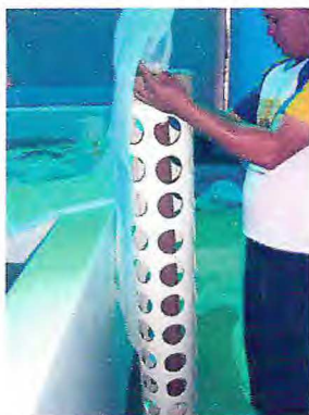
Figura 35 – Detalhe da troca de tela de um dos tanques.
