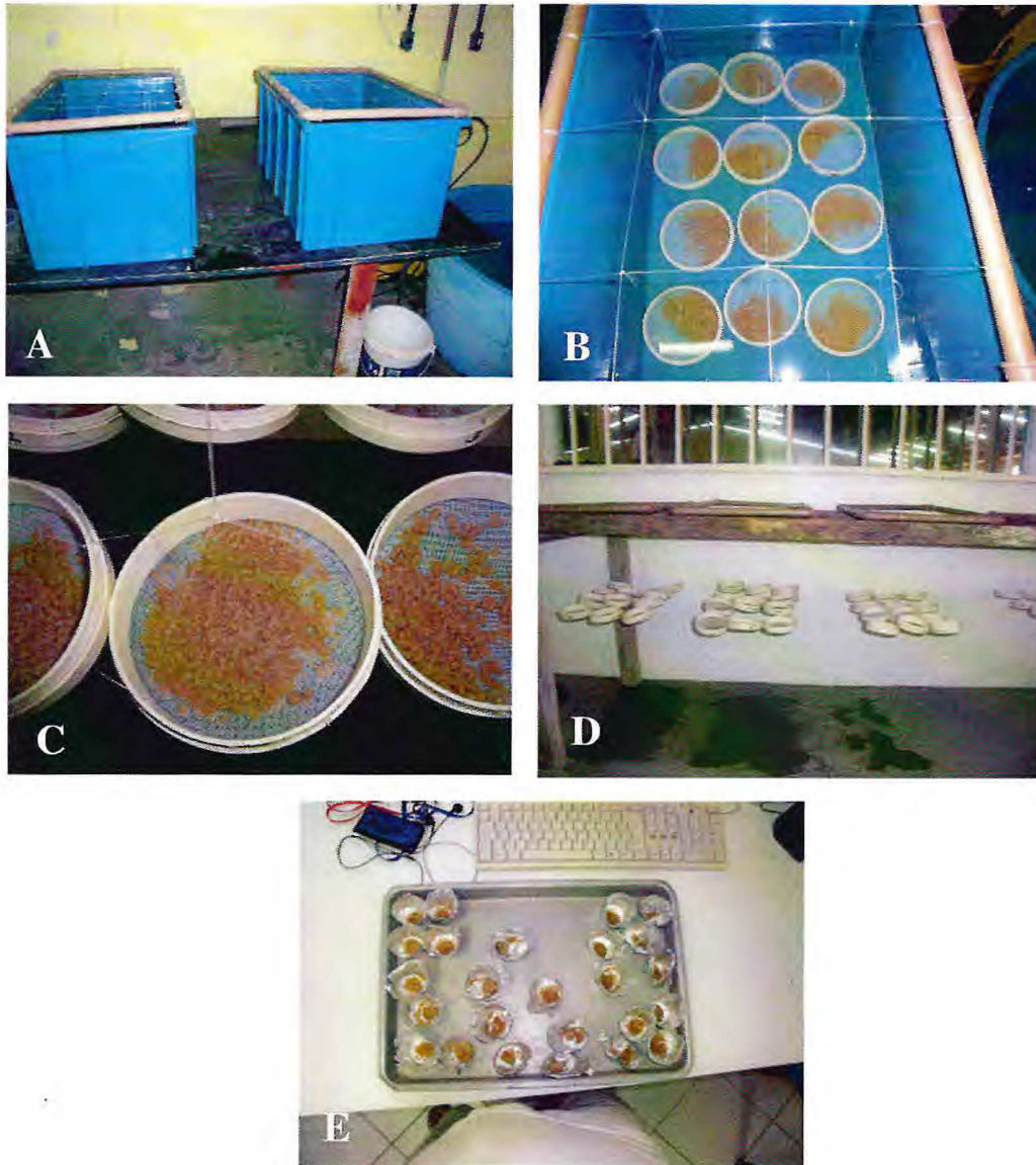
Figura 3 - Determinação da lixiviação de matéria seca das dietas experimentais. A, tanques de 60 L com água salgada. B, dietas experimentais nas bandejas de alimentação durante imersão em água. C, dietas após imersão em água. D, drenagem do excesso de água antes da secagem em estufa. E, dietas em papel alumínio para secagem em estufa.
