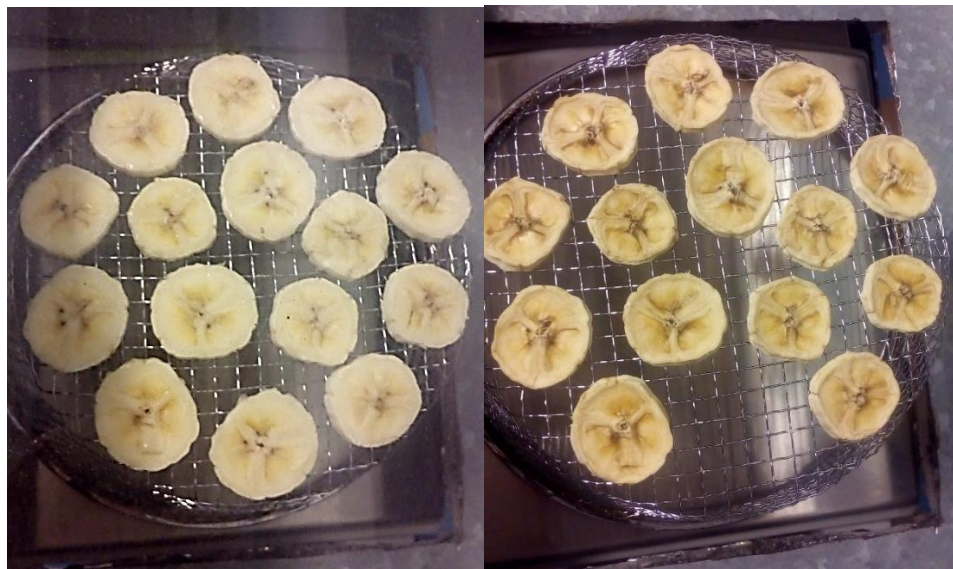
Figura 33 – Imagens da amostra de fatias de bananas descascadas antes (esquerda) e depois (direita) do experimento de secagem.
