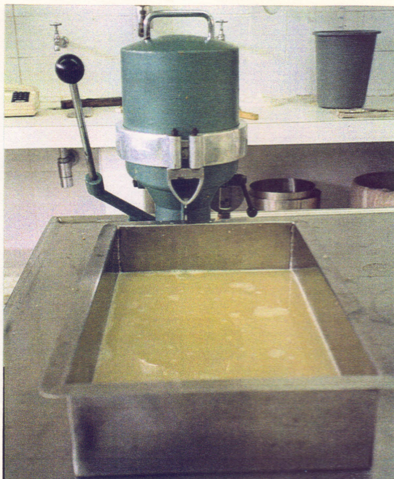
FIGURA 05: Fotografia da separação em prensa hidráulica do caldo gorduroso e resíduos sólidos.
