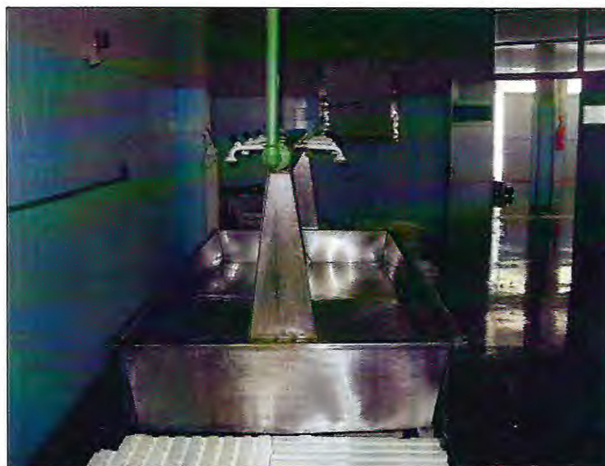
Figura 11 - Mesa de aço inox dotada de chuveiros verticais, utilizados no recebimento das caudas de lagosta, na INTERFRIOS – Intercâmbio de Frios S/A, em Fortaleza, Ceará.
