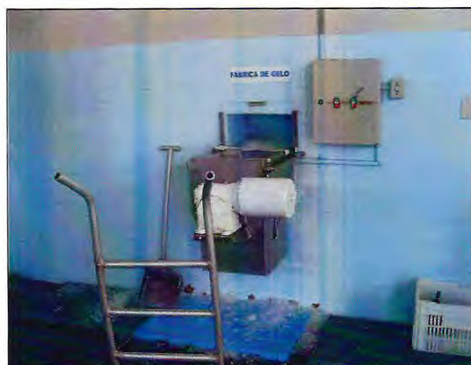
Figura 6 - Equipamento de liberação do gelo em escamas após fabricação, na indústria INTERFRIOS – Intercâmbio de Frios S/A, em Fortaleza, Ceará.
