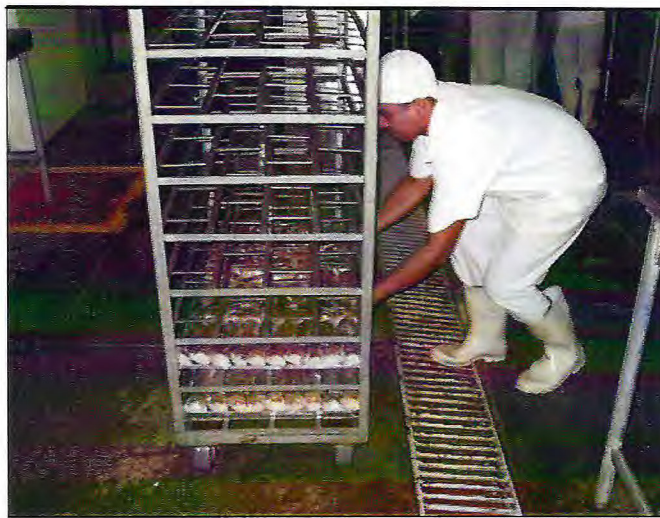
Figura 21 - Carro porta-bandejas, sendo encaminhado ao túnel de congelamento, na INTERFRIOS – Intercâmbio de Frios S/A, em Fortaleza, Ceará.
