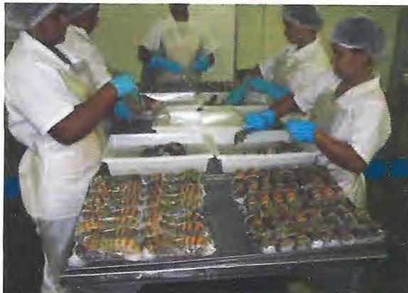
**Figura 26** – Funcionárias envolvendo individualmente as caudas de lagosta com filme plástico.
