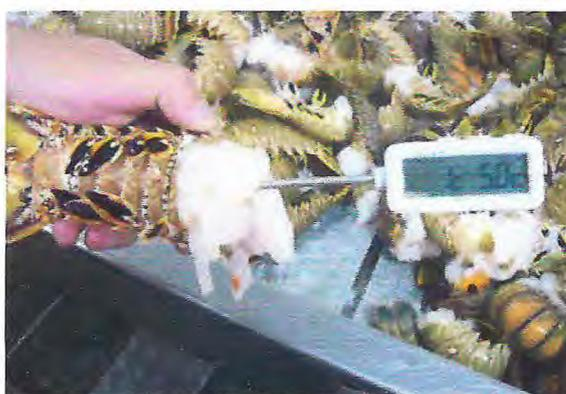
**Figura 14** – Termômetro de haste longa (tipo “espeto”) utilizado no recebimento das caudas de lagosta, na INTERFRIOS.
