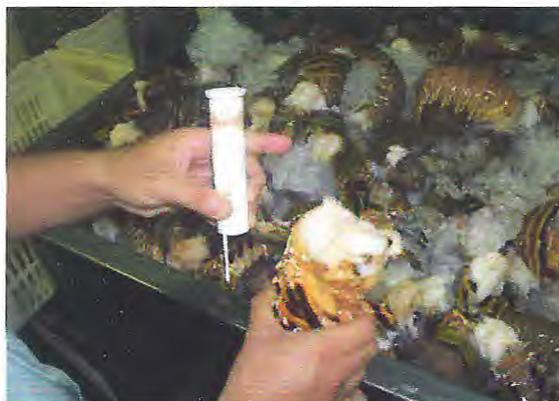
**Figura 15** – Fita MERCK utilizada para a determinação preliminar do teor de  $\text{SO}_2$  residual nas caudas de lagosta, na INTERFRIOS.
