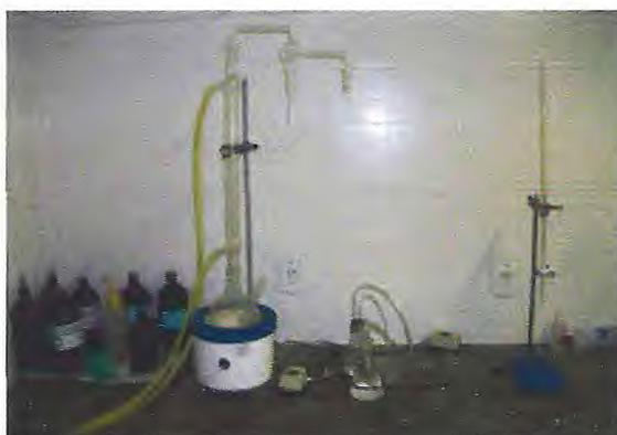
**Figura 39** – Aparelhagem para determinação do teor de SO<sub>2</sub> residual pelo método de Monnier-Williams.
