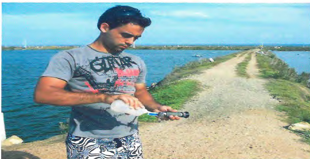
Figura 5 – Refratômetro sendo calibrado para posterior verificação da salinidade
