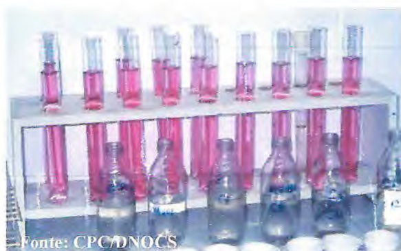
Fonte: CPC/DNOCS Figura 16 - Resultados do teste de nitrito nos tanques de desenvolvimento larval.
