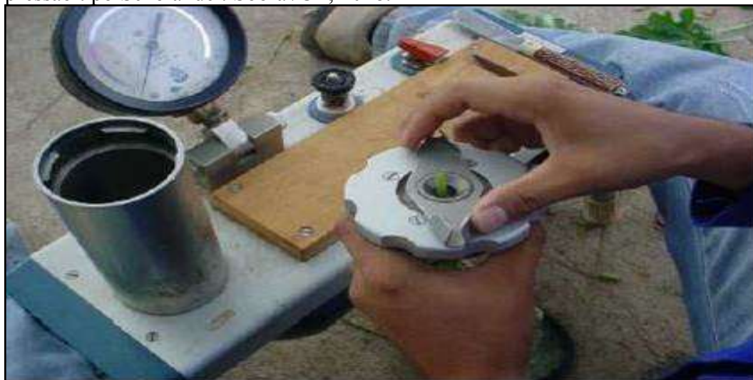
Figura 13 - Determinação do potencial hídrico foliar utilizando-se a bomba de pressão tipo Scholander. Sobral/CE, 2018.
