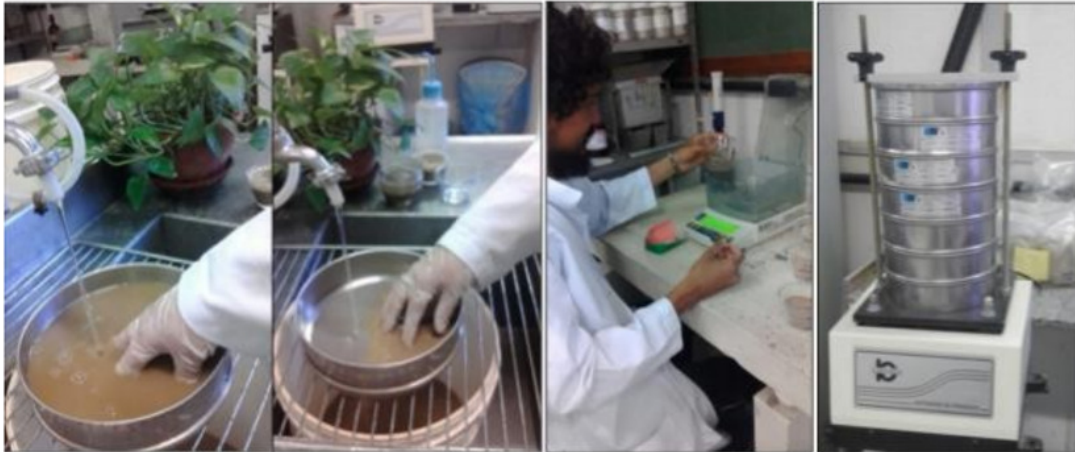
Figura 06: Etapas da análise granulométrica. Peneiramento úmido, pesagem e peneiramento mecânico.
