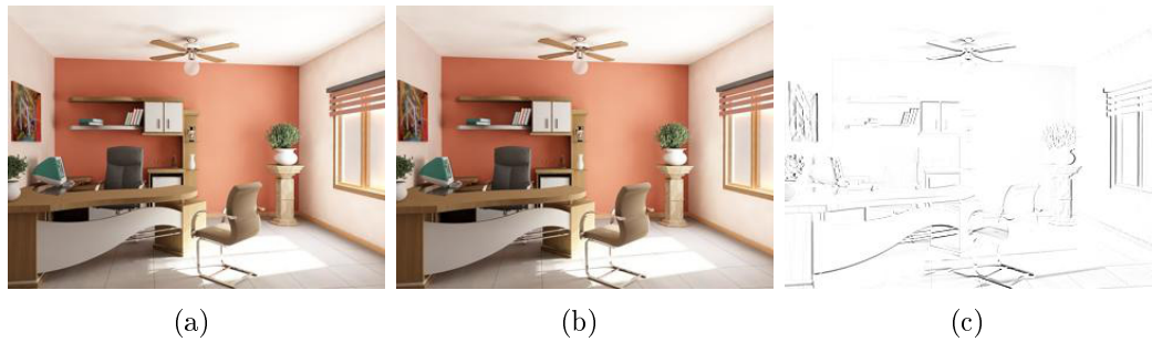
Figura 6.5: diferença temporal durante a realização de um movimento de rotação com velocidade angular de 5 graus por quadro. a) e b) quadros adquiridos em dois instantes de tempo consecutivos; c) diferença temporal.
