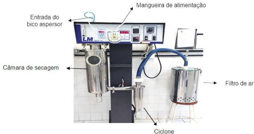
Figura 1 – Esquema do equipamento spray dryer presente no LACONSA/DEAL/ UFC.
