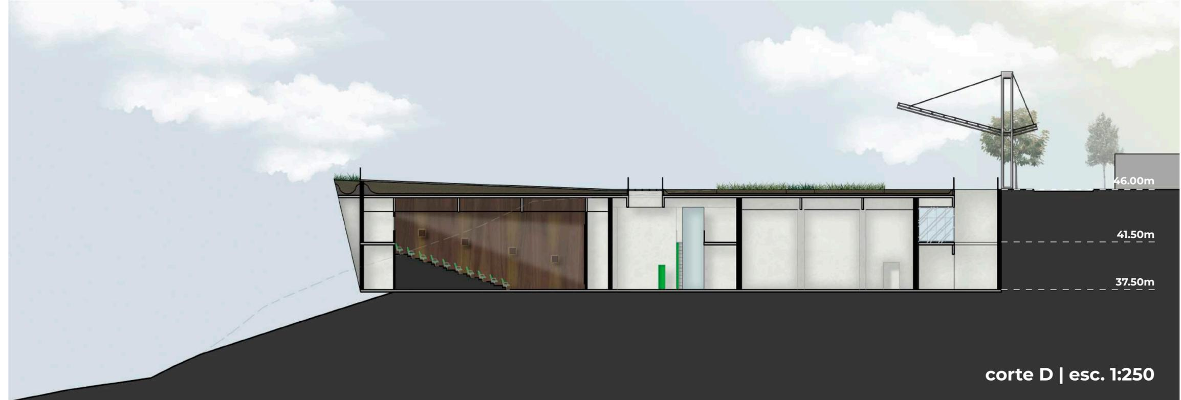
O edifício possui estrutura predominantemente de concreto. Todo o perímetro leste do prédio é contornado por paredes grossas de contenção, pois é essa a face que encontra diretamente com o terreno e faz a barragem dos sedimentos de terra que circundam o local.
