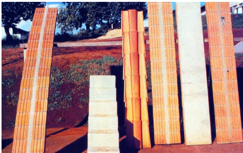
Figura 40 – Da direita para a esquerda: painel de instalações, painel de parede acabado, painel de parede, painel de laje, painel de cobertura plana, painel de escada e painel de cobertura curva, Unicamp, Campinas
