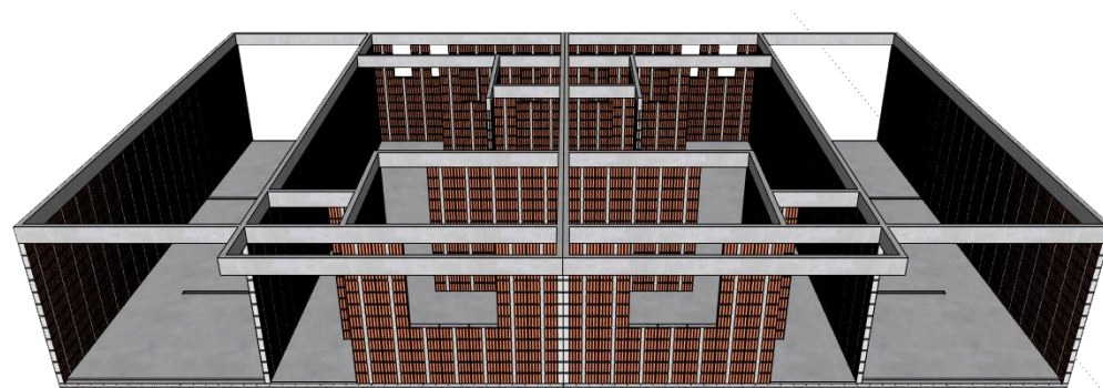
Figura 106 – Montagem dos painéis sobre o radier e da cinta de amarração sobre os painéis
