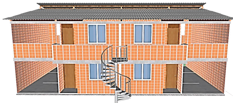
Figura 112 – Fachada frontal do bloco ModuLar, com acesso superior via escada helicoidal externa
