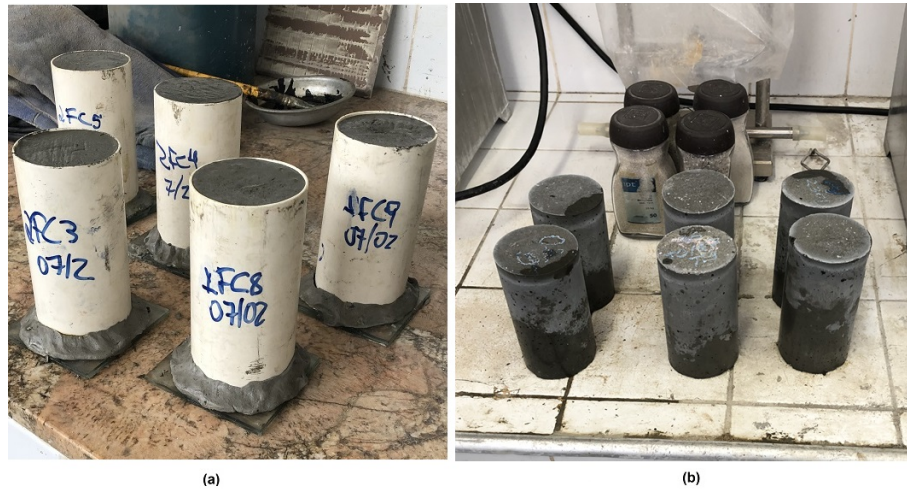
Figura 40 – (a) Moldes para corpos de prova de ensaio à compressão e (b) corpos de prova desmoldados
