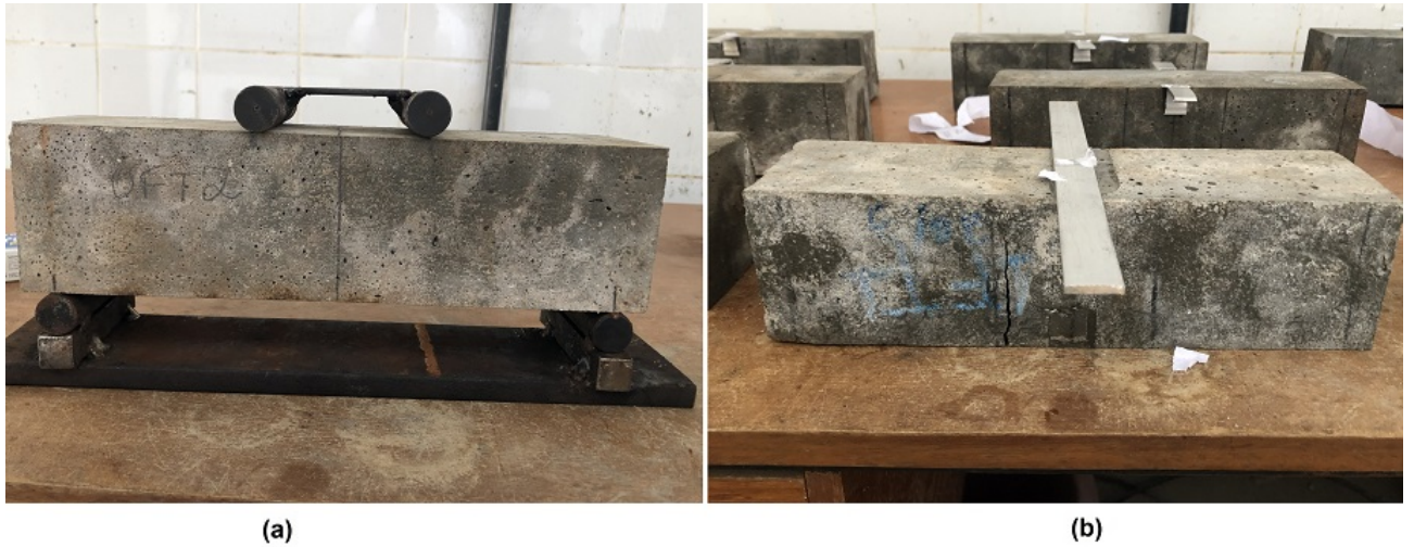
Figura 47 – Adaptações ao ensaio de tração na flexão: (a) suporte para apoio e aplicação de carga e (b) suporte para posicionamento dos LVDTs
