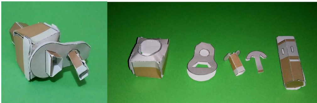
Figura 89 - Teste do sistema do Nintendo Labo™ que contém a manivela e o eixo
