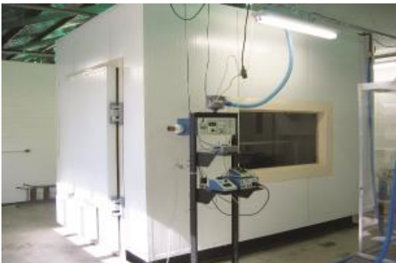
Figura 2 – Câmara respirométrica para mensuração de CH 4
