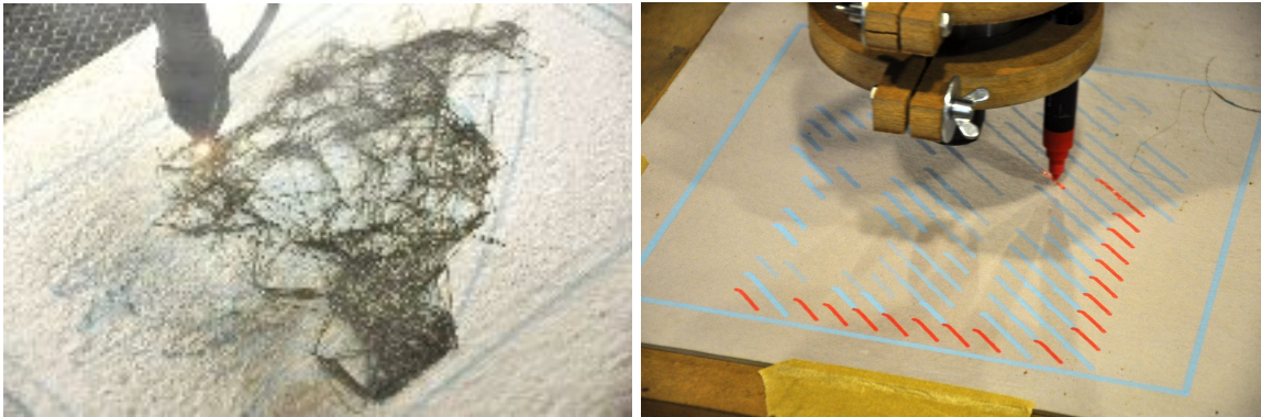
Figura 2 - Exemplos de materialização, utilizando gravação a laser e caneta adaptada à fresadora CNC.
