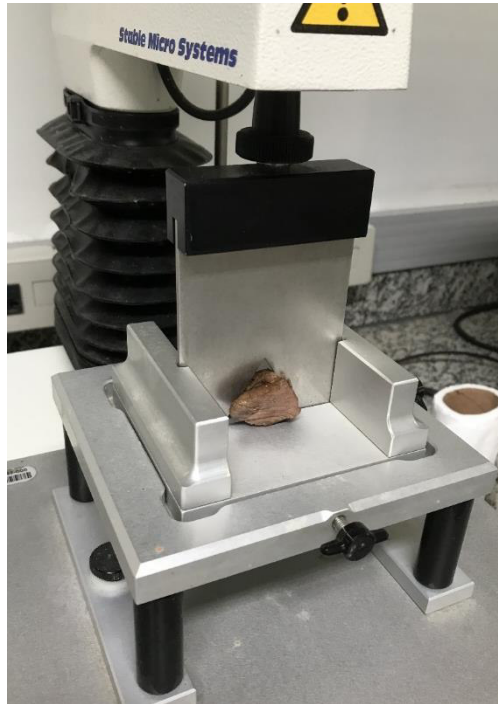
Figura 10 – Texturômetro XT Plus Texture Analyser ® no momento do corte da amostra
