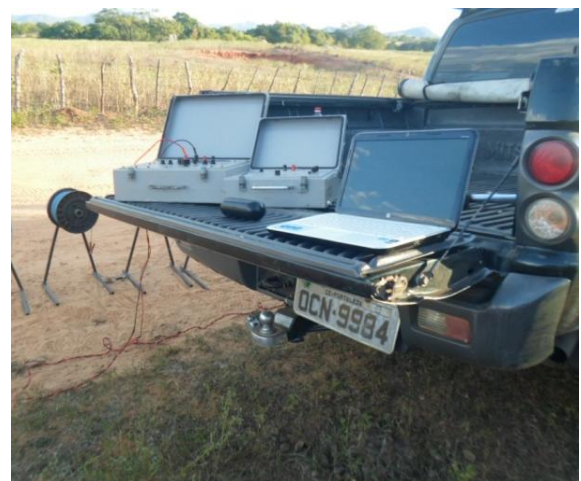
Figura 18 – Fotografias mostrando os dois resistivímetros utilizados para coleta das medidas de resistividade aparente em campo com auxílio de um notebook, bobinas e eletrodos para injeção de corrente elétrica e recepção da medida de diferença de potencial.
