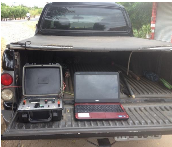
Figura 18 – Fotografias mostrando os dois resistivímetros utilizados para coleta das medidas de resistividade aparente em campo com auxílio de um notebook, bobinas e eletrodos para injeção de corrente elétrica e recepção da medida de diferença de potencial.
