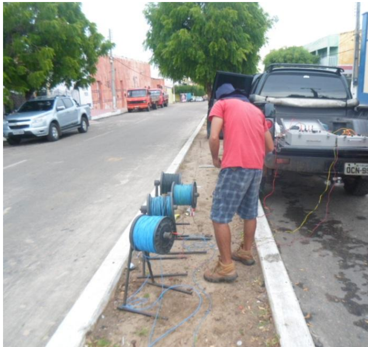
Figura 17 – Aquisição dos dados de resistividade, arranjo gradiente na sede do município de Iracema.
