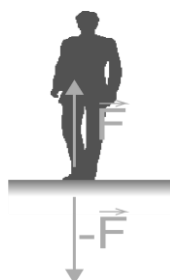
Figura 33 - Note que nem o homem, nem o piso sofrem mudanças de estado devido à aplicação da força de contato F .
