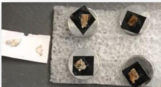
Figura 18 – Preparação de amostras para microscopia eletrônica de varredura (MEV).
