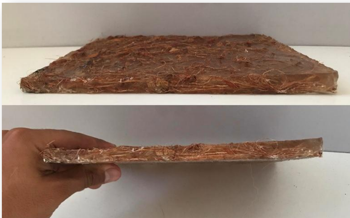
Figura 27 – Material compósito à base de fibra de Coco com resina de poliéster insaturado, mostrando a superfície da amostra endurecida (acima) e seção transversal (abaixo).
