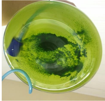
Figura 8 – Sedimentação de biomassa de Scenedesmus sp. nas paredes internas do erlenmeyer, em decorrência do processo de autoflocação
