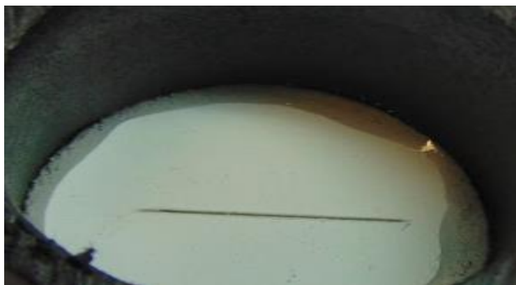
Figura 21- Amostras do aço carbono pintada e com risco para análise de monitoramento de OCP
