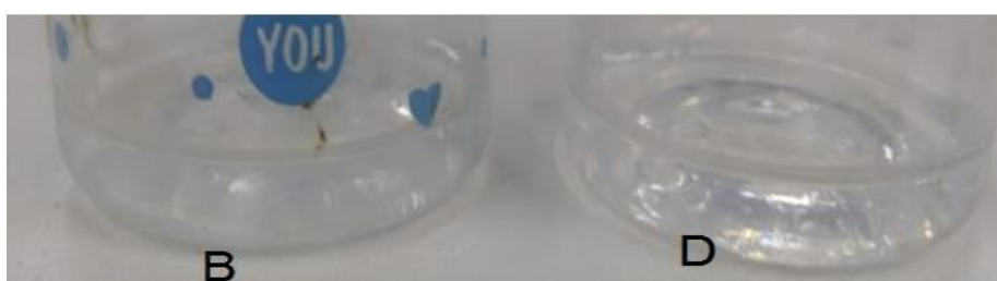
Figura 18 – Soluções B e D gelificadas após 24 horas
