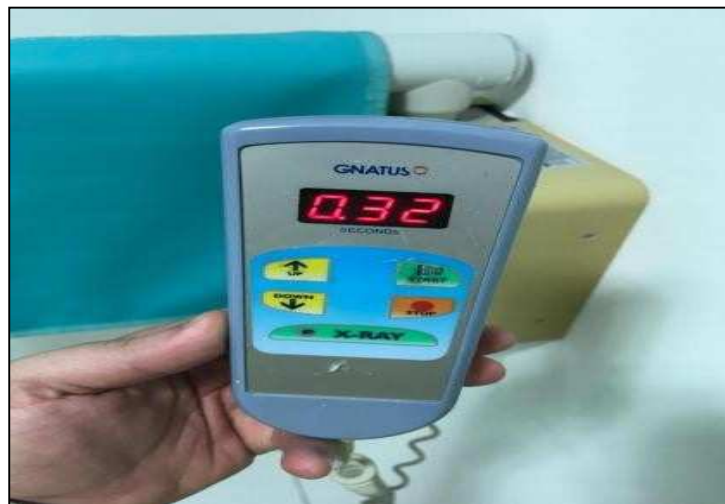
Figura 10 - Controle do equipamento de Raio X demonstrando o tempo de 0,32 segundos utilizado para aquisição da imagem.
