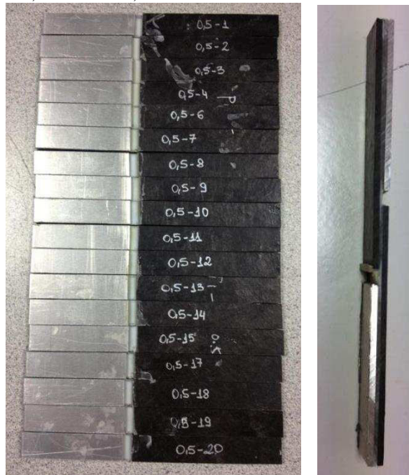
Figura 30 – A: Amostras da montagem colada para a espessura de 0,5mm de cola; B: Vista lateral da amostra colada
