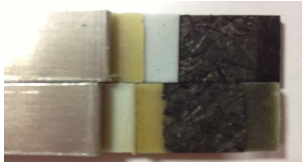
Figura 35 - Ruptura das amostras (espessura 0,5mm, velocidade 0,5m/s)
