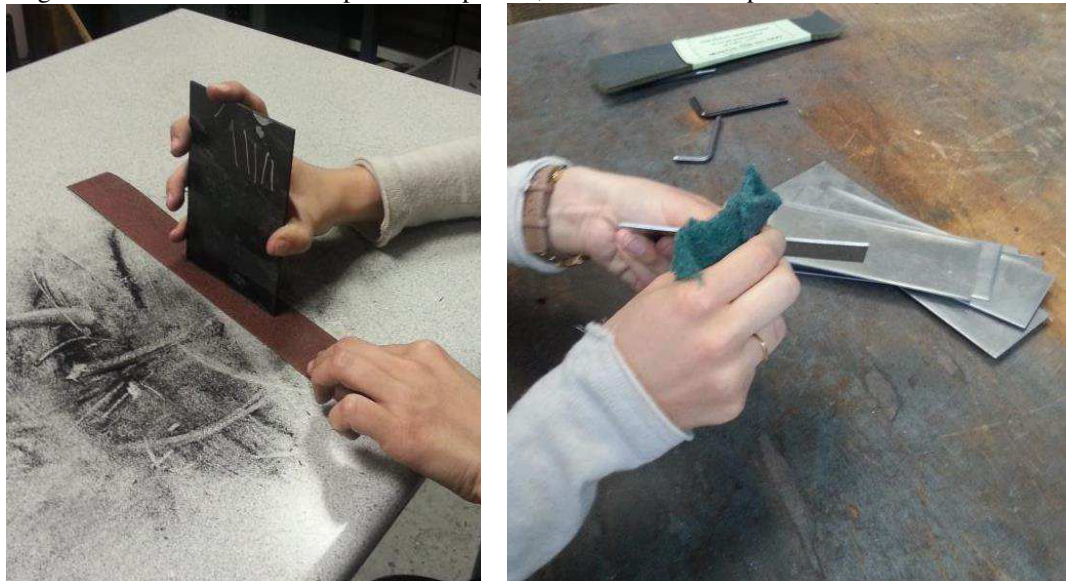
Figura 15 – A: Lixamento das placas compósitas; B: Lixamento das placas de alumínio
