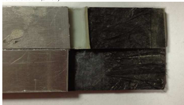
Figura 37 - Ruptura das amostras (espessura 0,5mm, velocidade 2,5m/s)
