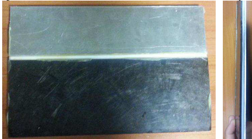
Figura 29 – A: Placa devidamente montada e colada; B: Vista lateral da placa
