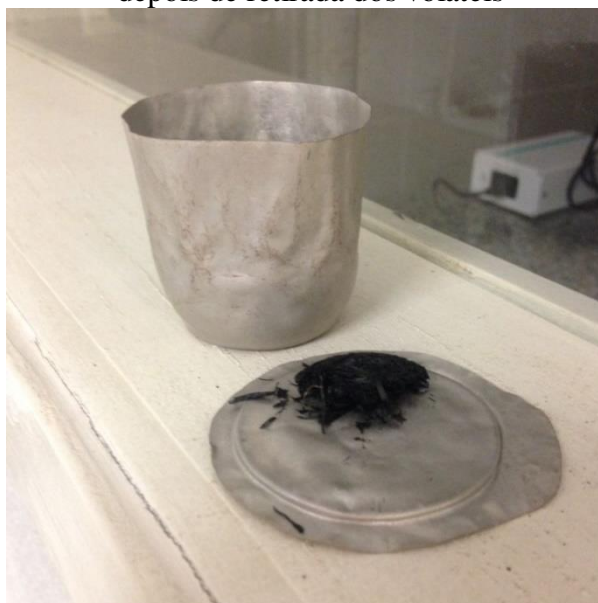
Figura 9 – Cadinho de platina com briquete depois de retirada dos voláteis
