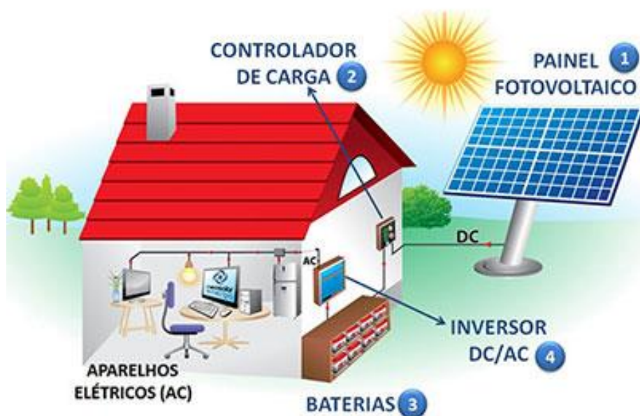
Figura 21: Sistema solar fotovoltaico off-grid.
