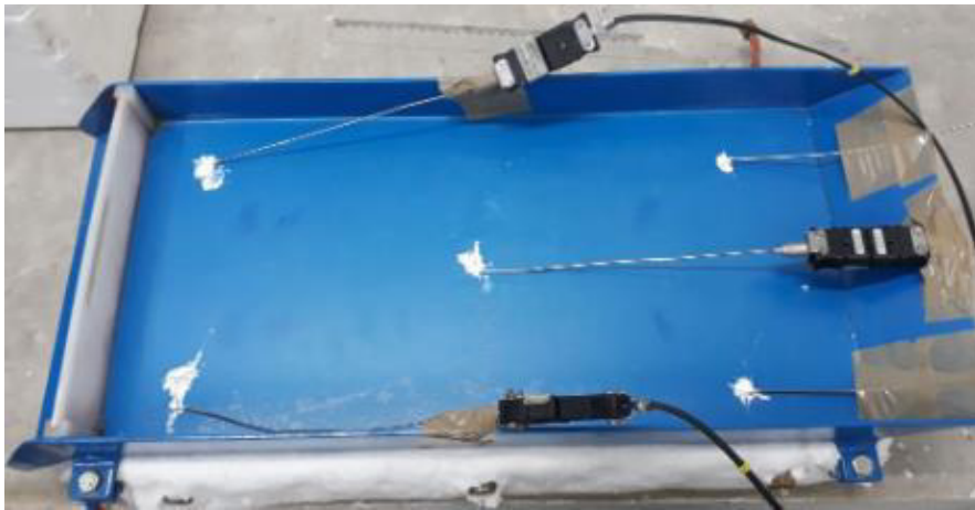
Figura 12 – Mapeamento sobre o piso radiante
