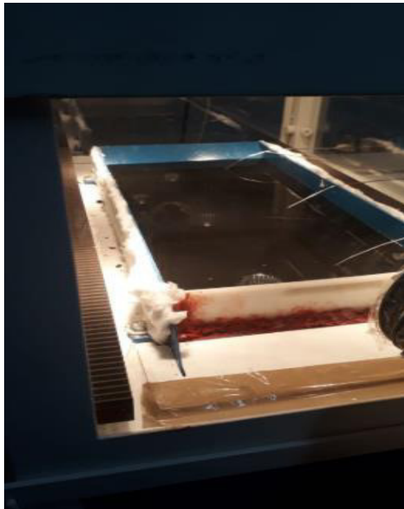
Figura 11 – Secagem do lodo com radiação simulada de Quixadá
