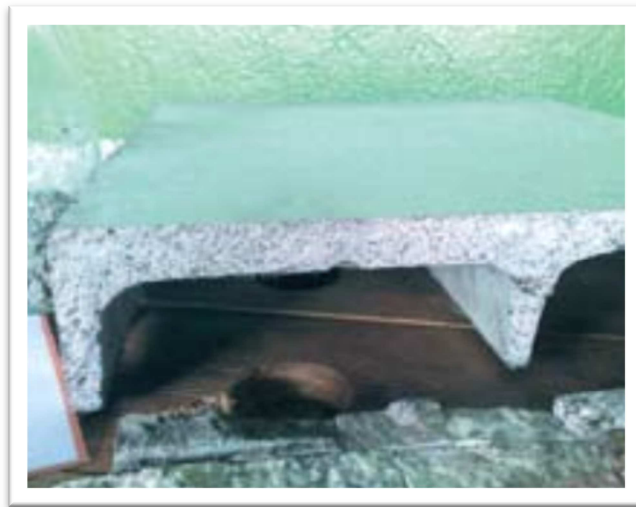
Figura 10 - Blocos de Concreto Utilizando Resíduos de Borracha
