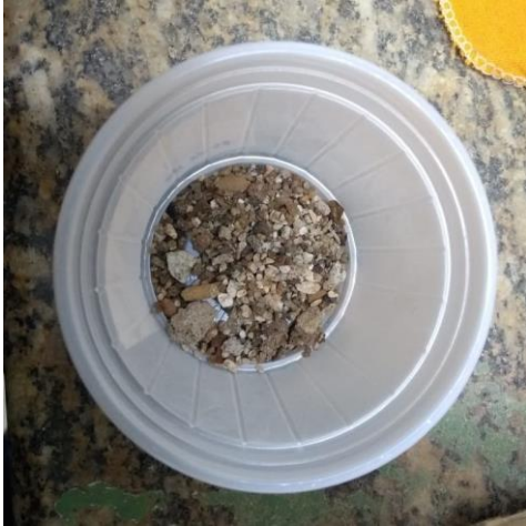
Figuras 16 – Amostra de areia na granulometria maior que 14 MESH ASTM.
