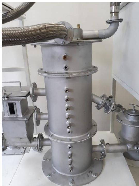
Figura 6 – Protótipo em escala de laboratório da caldeira de leito fluidizado.
