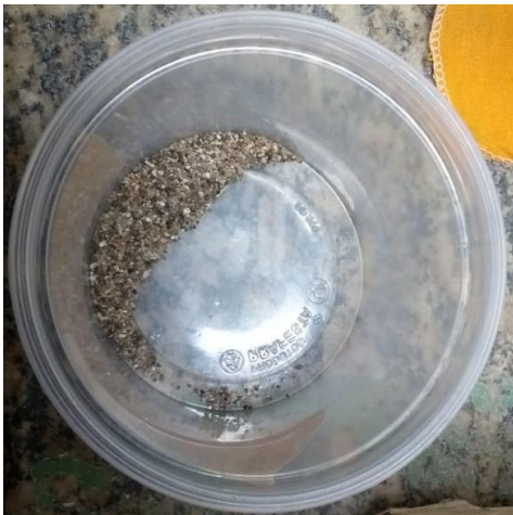
Figuras 17 – Amostra de areia na granulometria entre 14 e 20 MESH ASTM.
