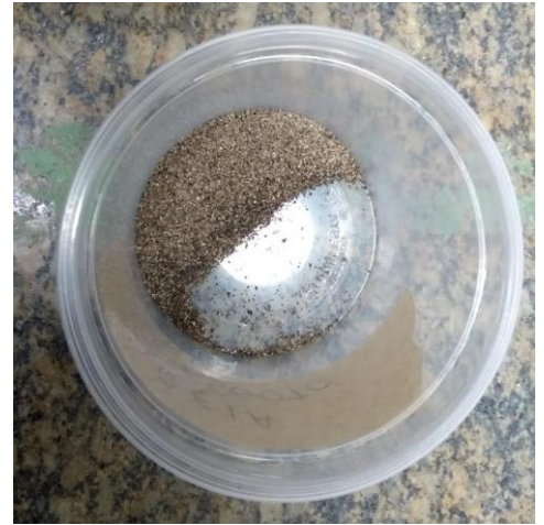
Figuras 18 – Amostra de areia na granulometria entre 20 e 45 MESH ASTM.
