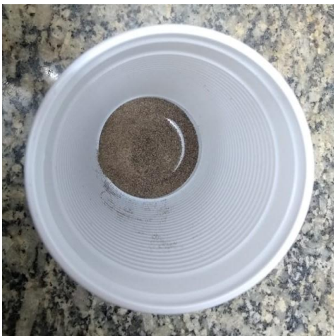
Figuras 21 – Amostra de areia na granulometria entre 100 e 120 MESH ASTM.
