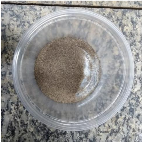
Figuras 20 – Amostra de areia na granulometria entre 50 e 100 MESH ASTM.
