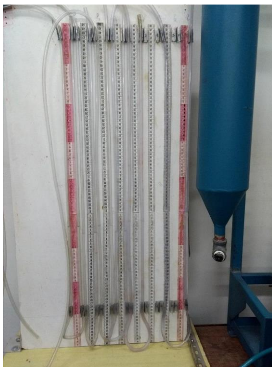
Figura 7 – Manômetro em U usado para medir pressão da base no leito.
