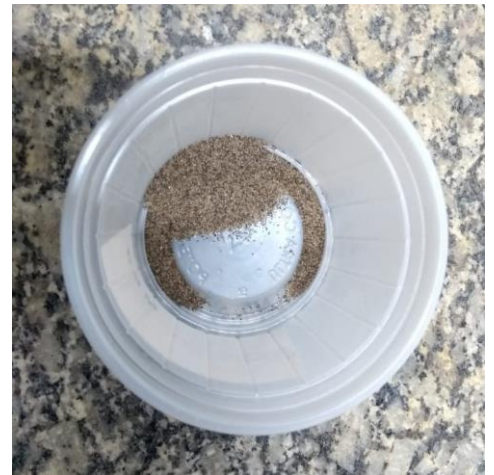
Figuras 19 – Amostra de areia na granulometria entre 45 e 50 MESH ASTM.
