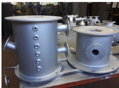
Figuras 11 – Peças do protótipo do reator de leito fluidizado.
