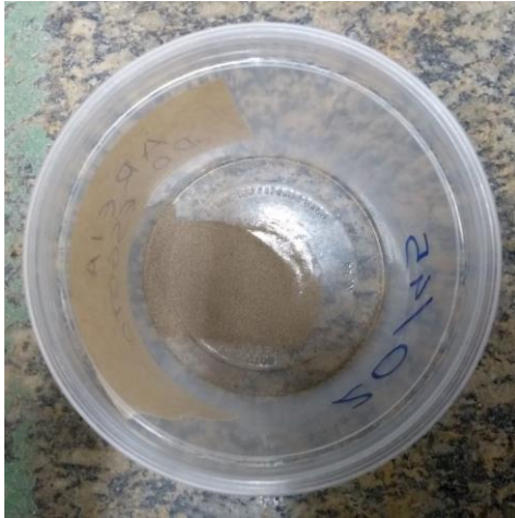
Figura 24 – Amostra de areia na granulometria menor que 200 MESH ASTM.
