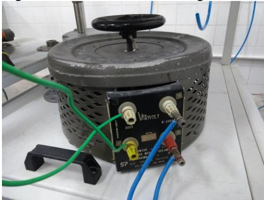
Figura 14 – Variador de tensão gradual (Varivolt).
