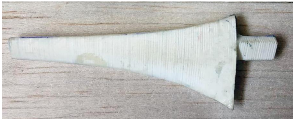
Figura 17 – Pás construídas por impressão 3D
