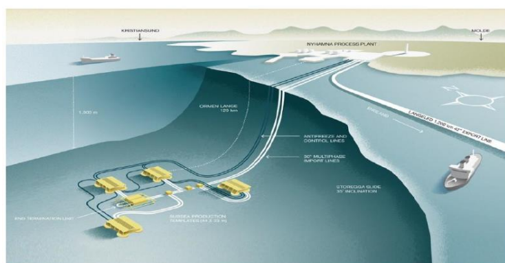
Figura 1- Sistema de produção subaquático
