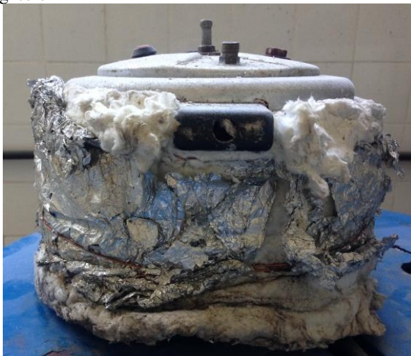
Figura 18 – Foto do aparato utilizado para a pirólise do glicerol
