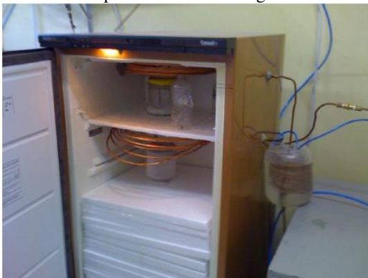
Figura 52 – foto do sistema de desumidificação das amostras para análise cromatográfica
