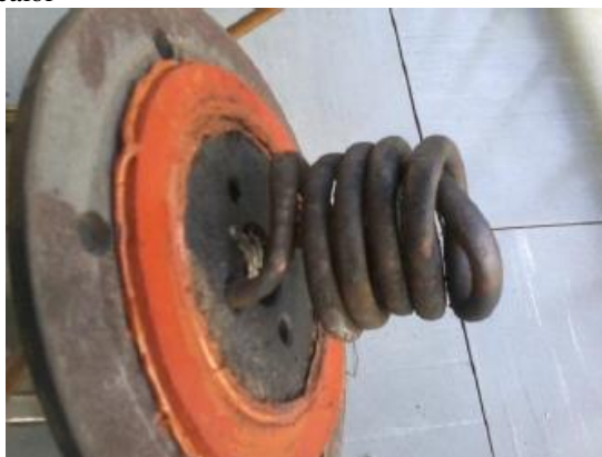
Figura 49 – Foto do flange superior do reator de oxidação parcial com tubulação do trocador de calor
