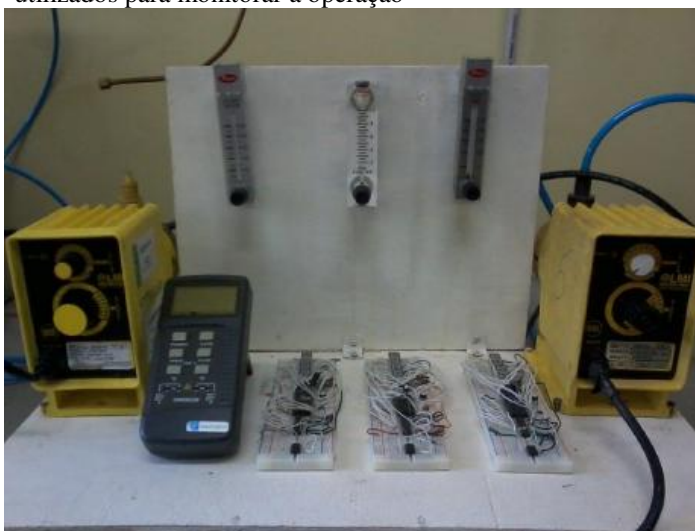
Figura 54 – Foto dos rotâmetros, bombas e termômetros utilizados para monitorar a operação
