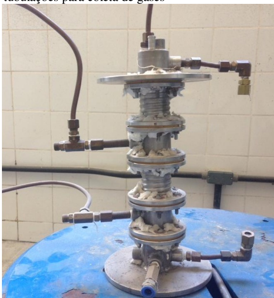
Figura 21 – Foto do reator de pirólise com tubulações para coleta de gases
