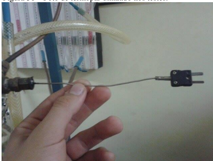
Figura 56 – Foto de termopar utilizado nos testes.
