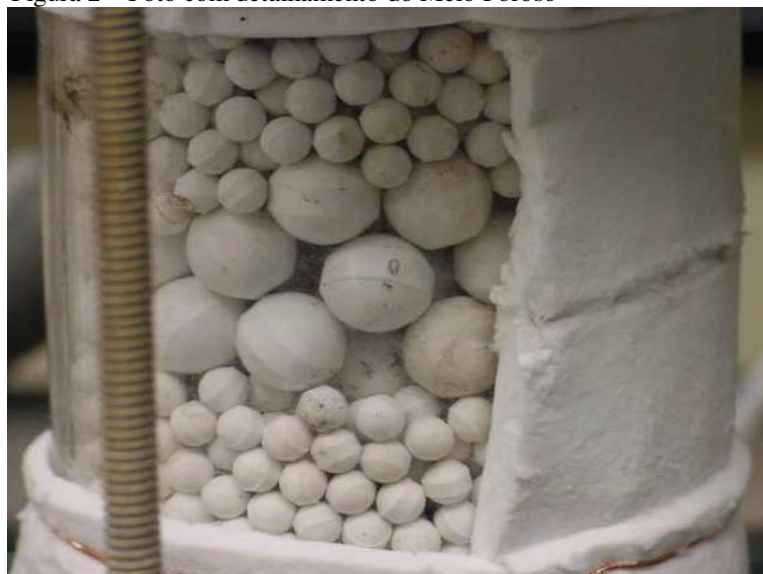
Figura 2 – Foto com detalhamento do Meio Poroso
