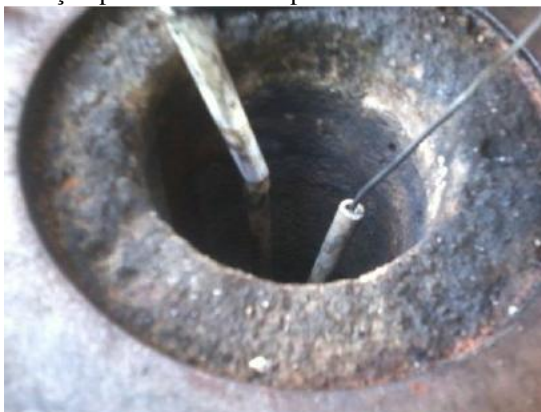
Figura 50 – Foto da resistência utilizada no reator de oxidação parcial envolvida por cerâmicas isolantes
