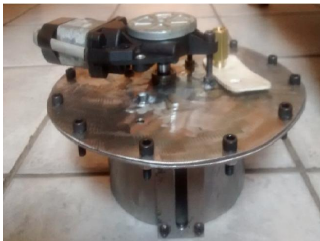
Figura 23 – Foto do aparato de bombeamento de óleo depois de montado
