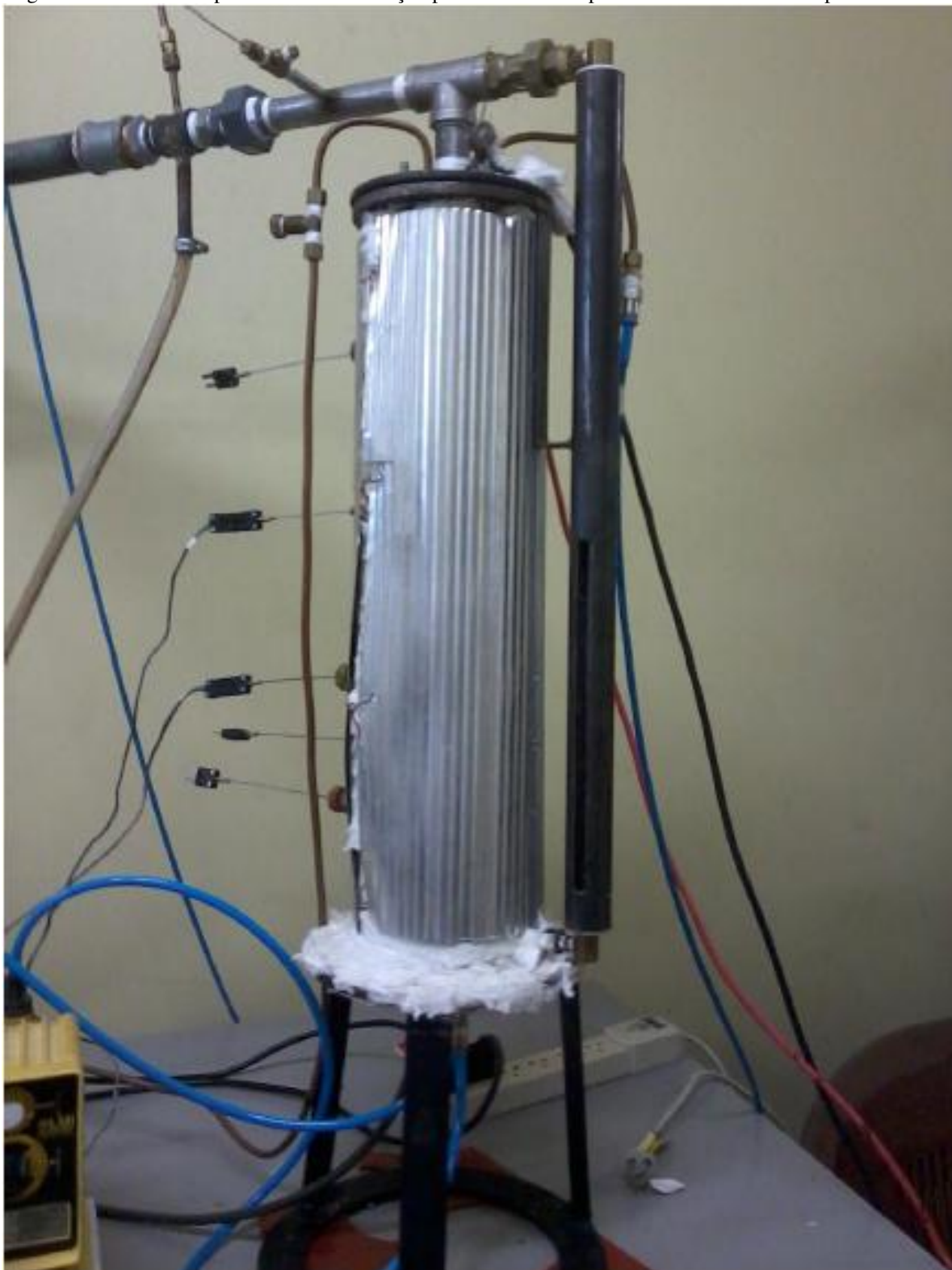
Figura 51 – Foto do corpo do reator de oxidação parcial com termopares inseridos em seu comprimento
