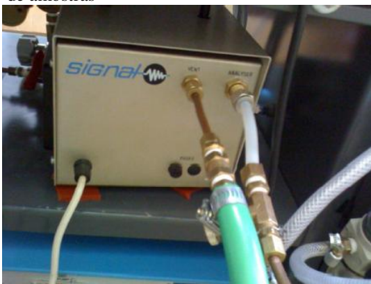
Figura 53 – foto da bomba de vácuo para coleta de amostras
