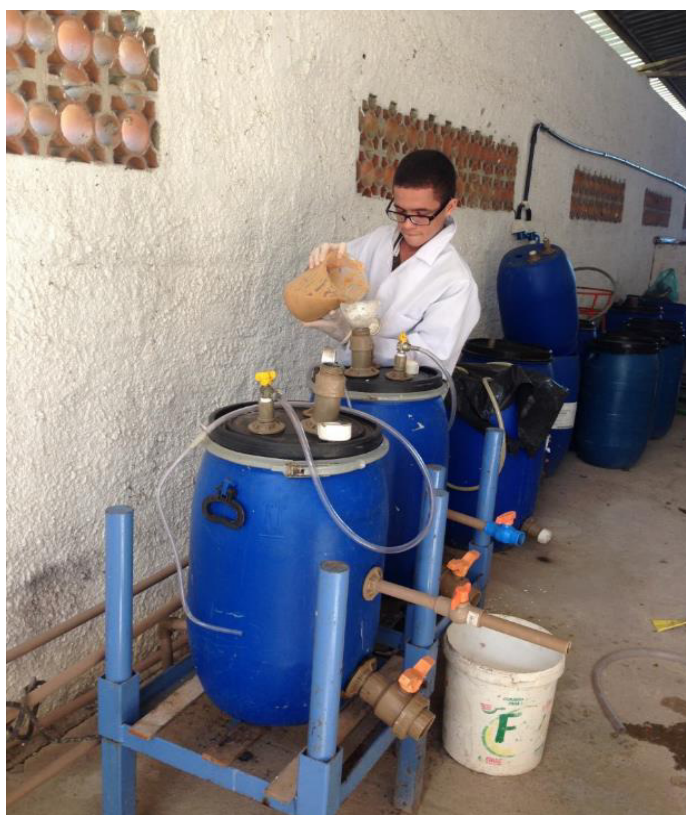
Figura 41 - Biodigestores utilizados na pesquisa
