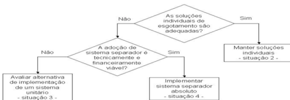
Figura 14 - Verificação de soluções de esgotamento sanitário
