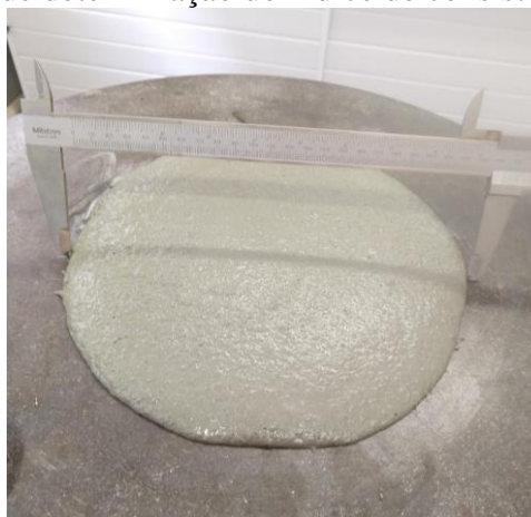
Figura 11 – Ensaio de determinação do índice de consistência das argamassas
