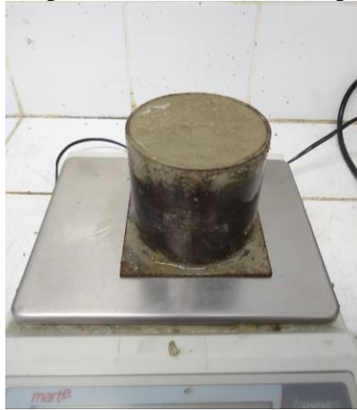
Figura 13 – Ensaio de retenção de água: a) amostra antes da sucção; b) amostra após sucção; c) equipamento de retenção de água
