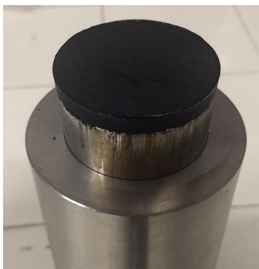
Figura 12 – Briquete formado pela palha de carnaúba carbonizada a 300 °C e torta residual de amêndoa do babaçu após a extração do óleo
