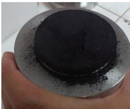
Figura 11 – Briquete de palha de carnaúba carbonizado a 300 °C
