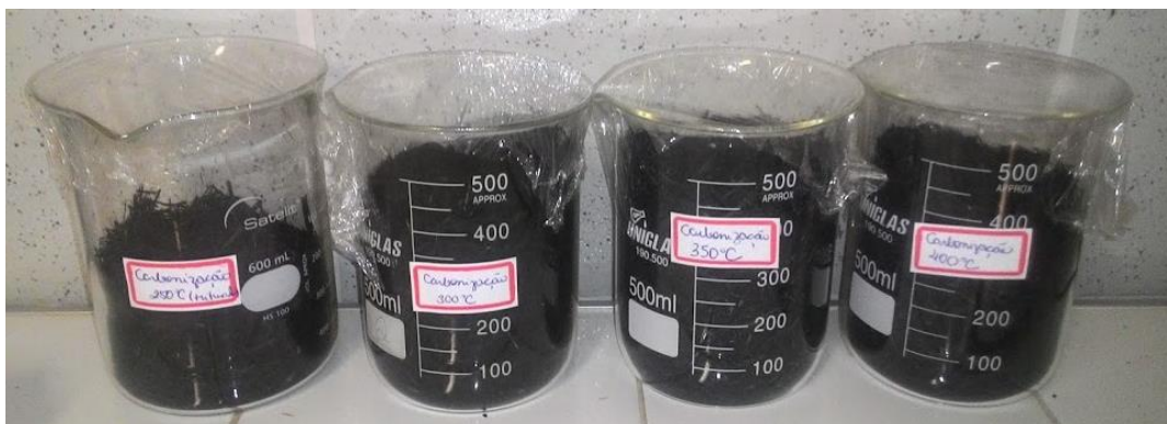
Figura 7 – Carbonização da palha de carnaúba (250 °C, 300 °C, 350 °C e 400 °C)
