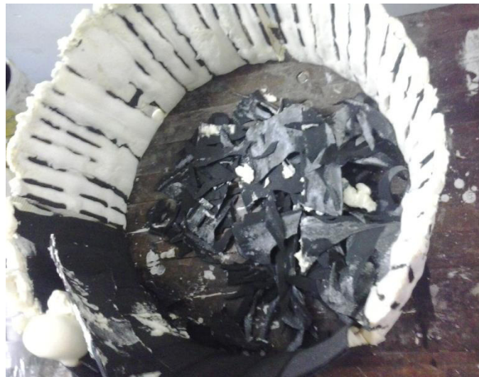
Figura 22: Processo de retirada do EVA com o poliuretano
