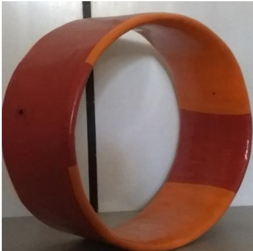
Figura 24 – Foto do Difusor com ângulo de ataque 4^\circ
