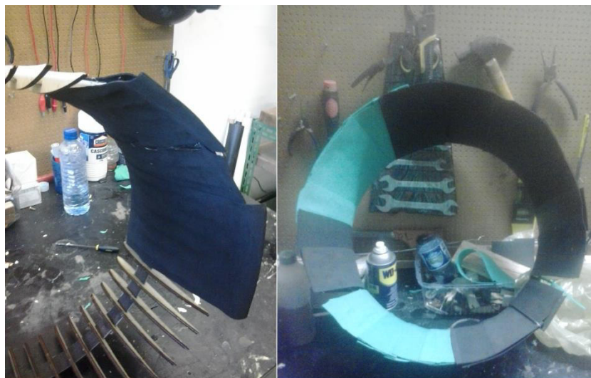
Figura 21 – Molde de EVA preenchido com poliuretano
