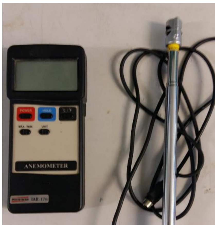
Figura 26: Foto do anemômetro utilizado nos testes
