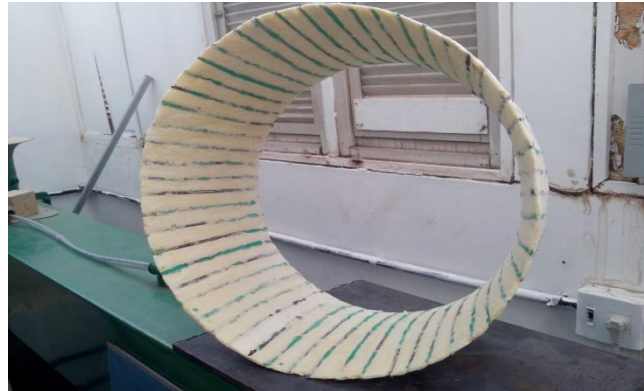
Figura 23 – Difusor preenchido com poliuretano e lixado
