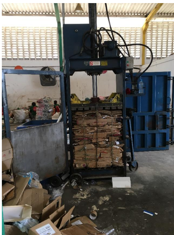
Figura 3.17 – Prensagem do papelão.
