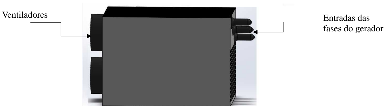
Figura 29 - Exemplo de banco de resistências projetado
