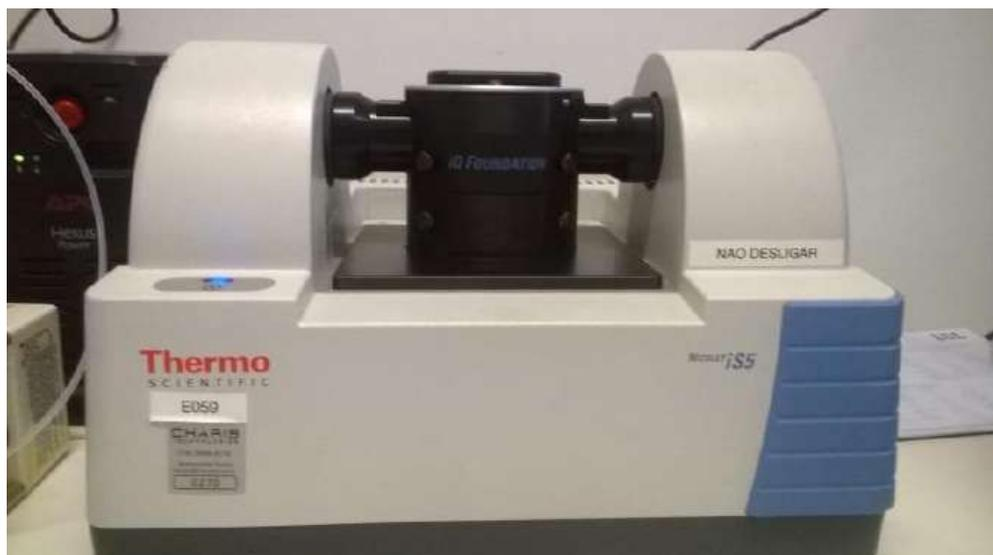
Figura 5 – Equipamento para análise de infravermelho com transformada de Fourier.
