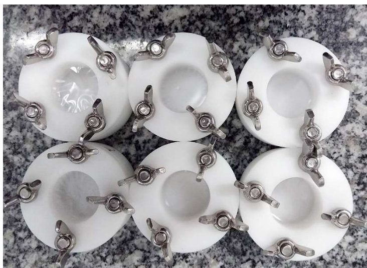
Figura 13: Células utilizadas na análise de permeabilidade ao vapor d'água.
