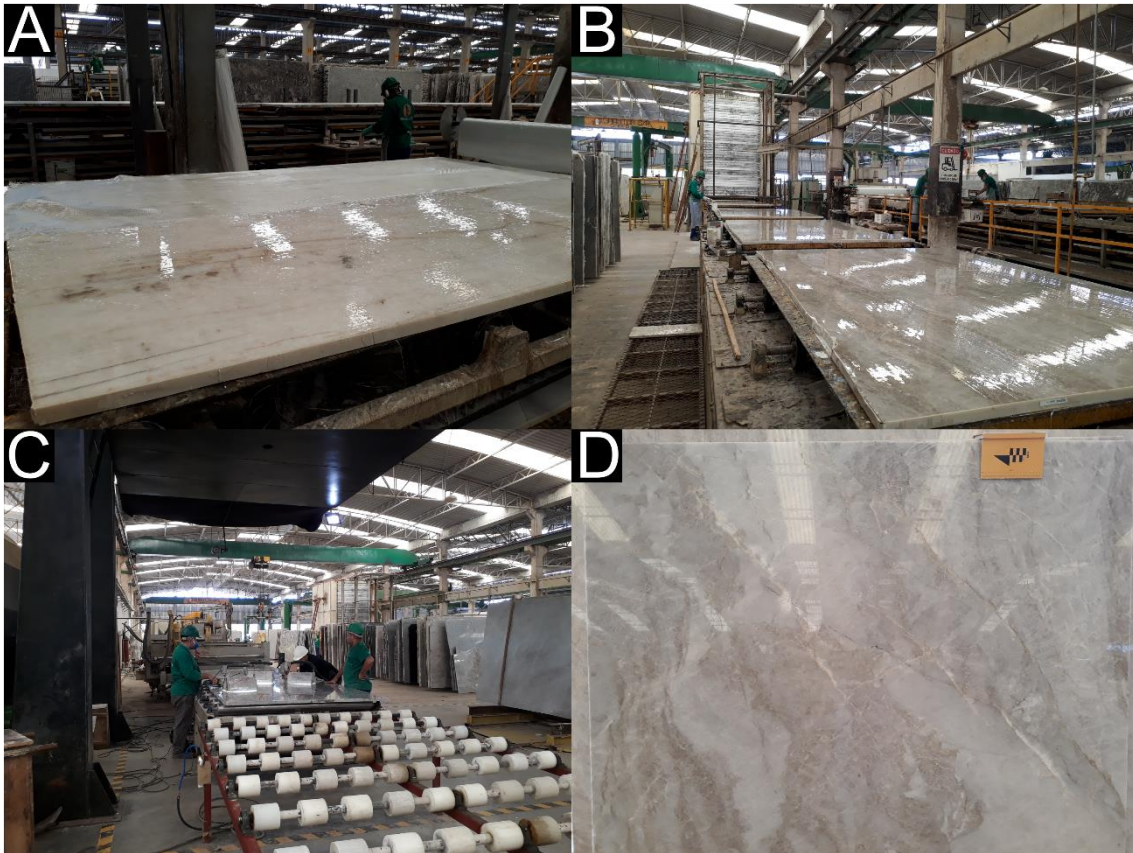
Figura 7: Etapas do processo de beneficiamento. A) aplicação de tela na chapa; B) aplicação de resina; C) polimento e estucamento; D) produto final.
